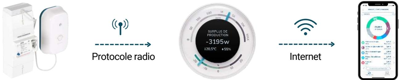
Le capteur, qui se pose sur le disjoncteur général, capte à distance le flux électrique qui passe à travers les fils du disjoncteur. Il récupère les mesures en continu et les transmet sans fil à l'assistant (protocole radio - portée de 50m) toutes les 5 à 10 secondes. L'afficheur s'installe dans une pièce à vivre et affiche les mesures en temps réel. L'assistant envoie ensuite les informations jusqu'à l'application, sur laquelle toutes les mesures de consommation sont disponibles.
